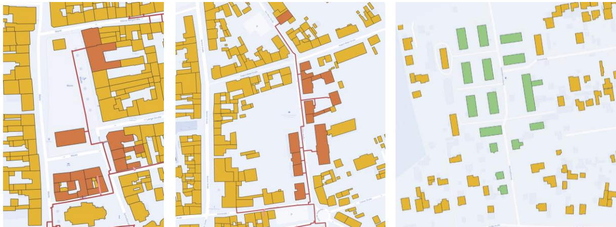
Abbildung 5.11: Verbrauchsstellen für die Validierung des Wärmebedarfsmodells (links: „Markt“ (Fernwärme), Mitte: „Karl-Marx-Str.“ (Fernwärme), rechts: „Heimstättensiedlung“ (Erdgas). Rot koloriert sind bilanzierte Gebäude mit Fernwärmeversorgung, grün koloriert sind bilanzierte Gebäude mit Erdgasversorgung.
