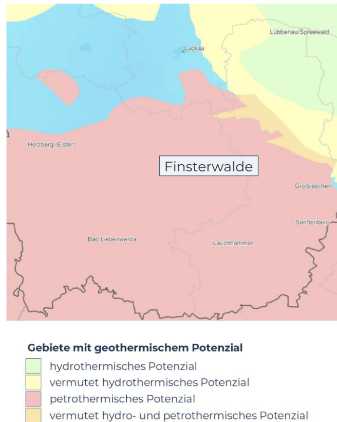
Abbildung 6-10: Potenzial von Tiefengeothermie
